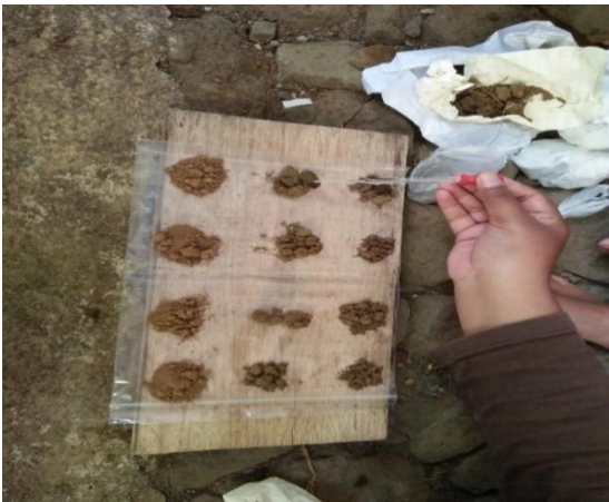
Gambar 12. Pengujian Drainase Tanah
