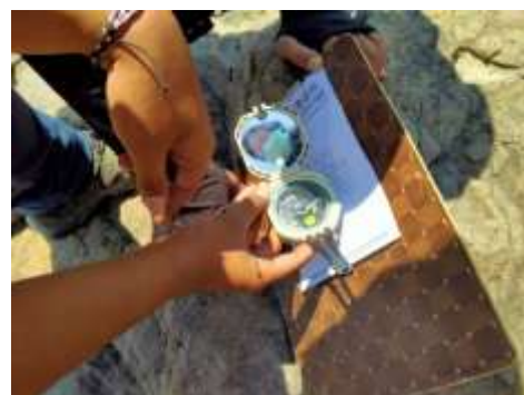
Gambar 1. Menentukan arah kekar dengan kompas geologi
